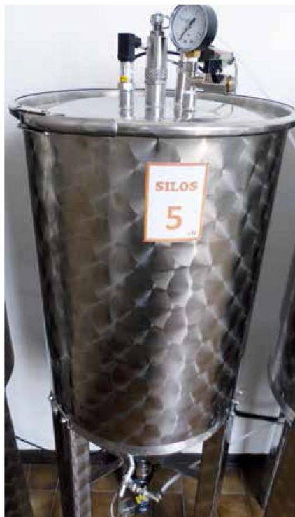
Figura 3 - Uno dei minisilos a tenuta con atmosfera controllata d'azoto: sul fondo si nota la valvola per l'immissione del gas, nella parte alta si distinguono invece una valvola per lo sfiato di sicurezza, un manometro e l'ingresso delle sonde con cui vengono rilevati i parametri di conservazione
