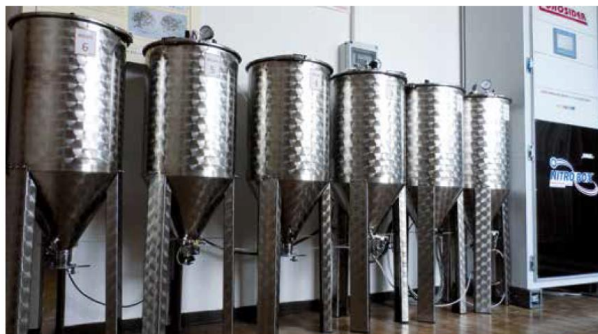
Figura 2 - I sei minisilos impiegati nella sperimentazione; nella parte destra della foto è visibile l'unità che contiene il filtro a membrane per la separazione dell'azoto dall'aria
